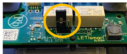
Fig.5 Posizione del jumper su "M"
