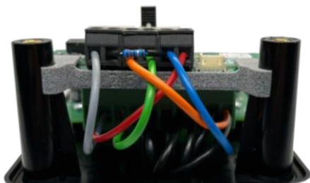
Fig. 8 Vista superiore pulsantiera con montaggio NO (standard)
