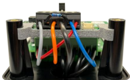
Fig. Vista superiore pulsantiera con montaggio NC (Milano)
