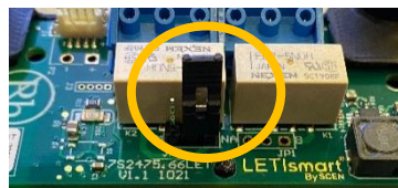
Fig.7 Posizione del jumper su "N"
